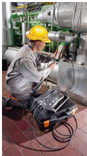
Figura 56 teste 350 – Sistema analisador de gases de combustão para medição de emissões industriais
