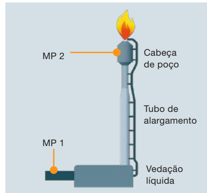
Figura 51 Estrutura de um sistema de queima
