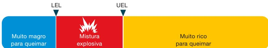
Figura 9 Representação esquemática da zona de risco de explosão
